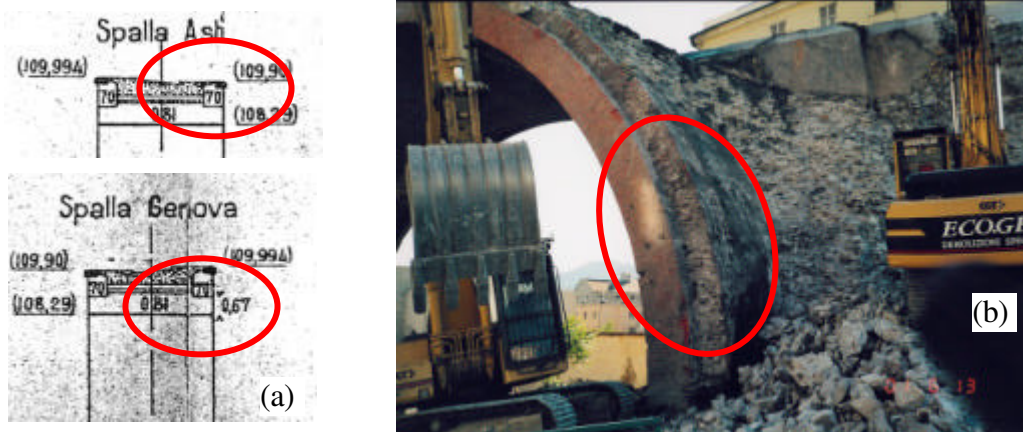
Figura 41.a,b Spessore dell'arcata inferiore nelle parti laterali: a) ponte sul Rio Botti alla progr. 11+248 della linea Genova-Ovada Acqui (Archivio FS – GE); b) ponte del raccordo ferroviario con la zona industriale di Genova Cornigliano (in corso di demolizione).
